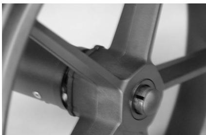
Druckknopf öffnen, Rad auf die Antriebs-Achse setzen
