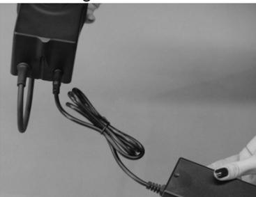
Erst wenn ein spürbarer Widerstand beim Anschluss an den Akku überwunden ist, sind Akku und Ladegerät korrekt verbunden. Der Ladevorgang kann beginnen.
