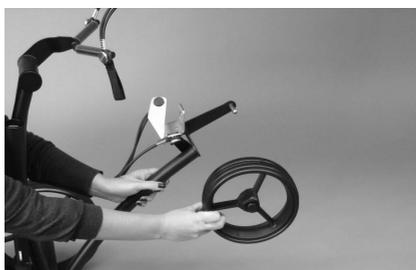
Vorderrad (geöffnet) auf die Vorderachse setzen. Abstand zum Achsschenkel halten und per Knopfdruck verriegeln. Trolley aufrichten.
